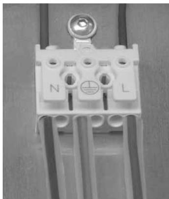
**3.** Schließen Sie daraufhin die drei Kabel an die vorgesehene Klemme in der Leuchte an. Dabei ist wichtig darauf zu achten, dass alle Kabel in die richtige Öffnung geklemmt werden. Links befindet sich der Nullleiter (N), blaues Kabel. In der Mitte befindet sich die Erdung, grün-gelbes Kabel. Rechts befindet sich die Phase (L), braunes oder schwarzes Kabel.
