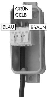
5. Schließen Sie daraufhin die drei Kabel an die vorgesehene Klemme in der Leuchte an. Dabei ist wichtig darauf zu achten, dass alle Kabel in die richtige Öffnung geklemmt werden. Links befindet sich der Nullleiter (blaues Kabel). In der Mitte befindet sich die Erdung (grün-gelbes Kabel). Rechts befindet sich die Phase L (braunes oder schwarzes Kabel).
